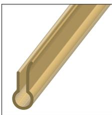
Canal de latón, inoxidable diseñado para reforzar la navaja de hule, logrando una la limpieza eficiente de los vidrios. Para reemplazar el hule se recomienda limpiar el canal, para evitar acumulaciones de residuos en el canal.
